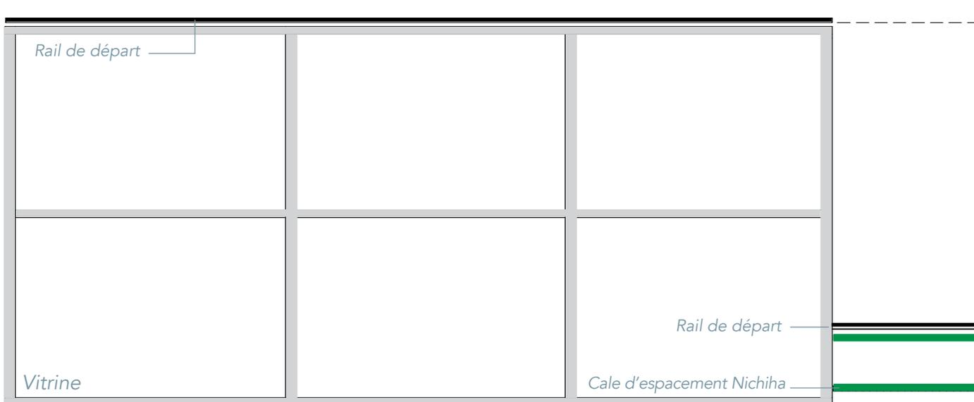
Utilisez stratégiquement le rail de départ sur le dessus et sur les côtés d'une grande ouverture pour déterminer et aligner les joints horizontaux des panneaux AWP.
