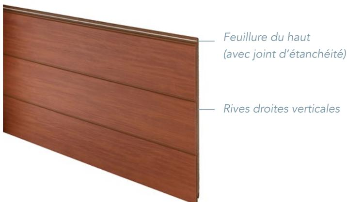
Seules les rives supérieures et inférieures des panneaux AWP 3030 sont à feuillure. Il y a un joint d'étanchéité sur la rive supérieure. Les rives verticales des panneaux AWP 3030 sont droites, nécessitant ainsi des supports d'étanchéité ou des moulures métalliques, et ne permettent qu'une disposition superposée des panneaux. Les rives droites verticales ne doivent jamais être aboutées directement ni décalées. Les panneaux AWP 3030 peuvent être installés horizontalement ou verticalement.
